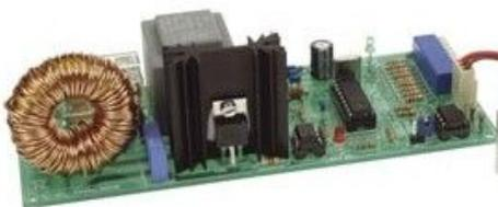
Gradateurs 2,5A pour lampe halogène
