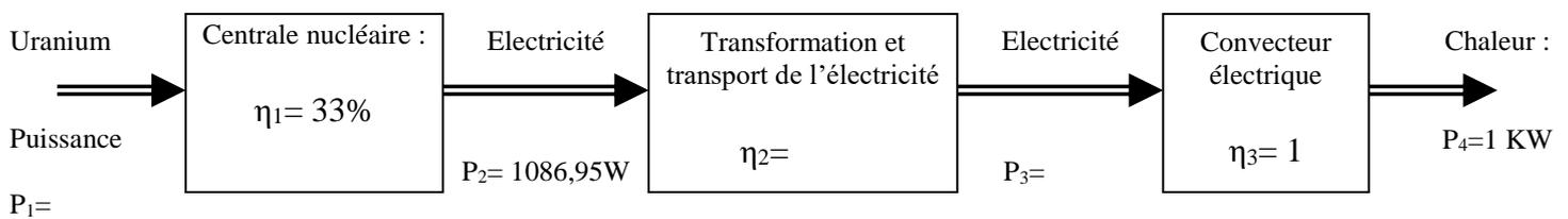
1. Calculer la puissance  $P_3$  nécessaire pour que le convecteur fournisse sa puissance nominale  $P_4$ . Compléter la chaîne énergétique avec la valeur calculée.
