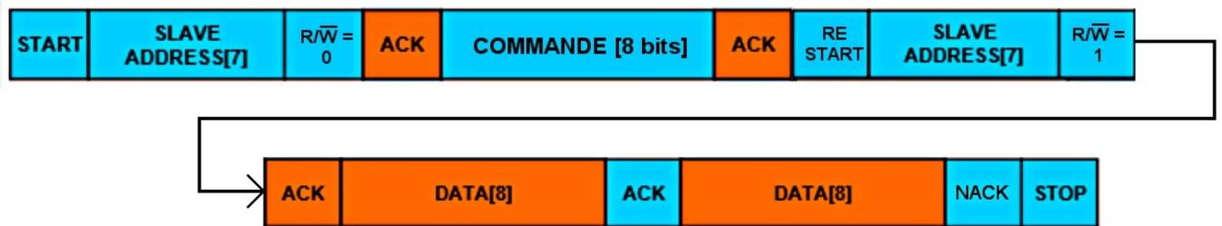
**On remarque que pour que le maître envoie une commande il faut mettre le bit R/W à 0 et pour que le maître lise les données envoyées par un esclave il faut mettre le bit R/W à 1**
